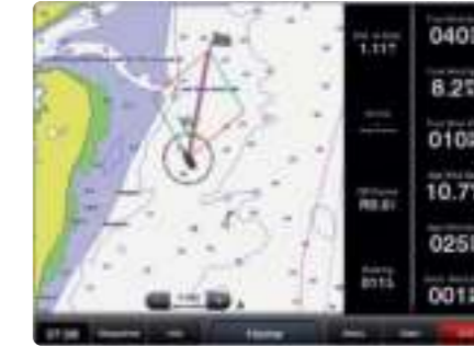
Sailing features: laylines, COG, true wind/apparent wind data displayed at the same time, etc. Fonctions Voile : laylines, COG, affichage simultané des données de vent réel/apparent, etc.
